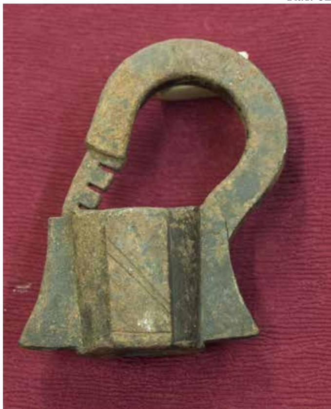
стержнем внутри. Дужка откидная четырёхгранная с тремя щелевидными прорезями на запорной части, находится в открытом положении. Ключи утрачены.
