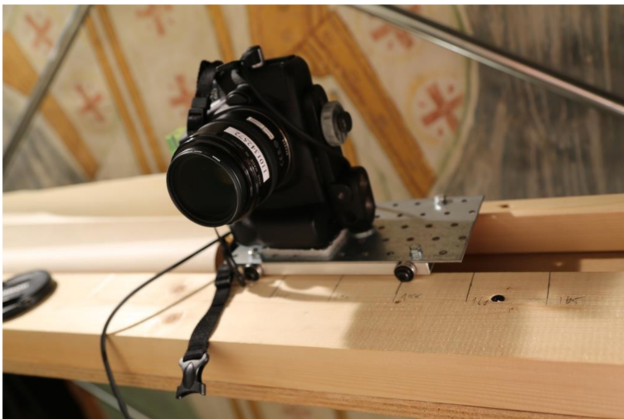
Фото 3. Слайдер с фотоаппаратом в рабочем состоянии.
